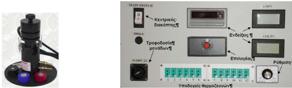
Σχήμα 3: Φωτογραφία του τοιχώματος και του πάνελ της πειραματικής συσκευής
