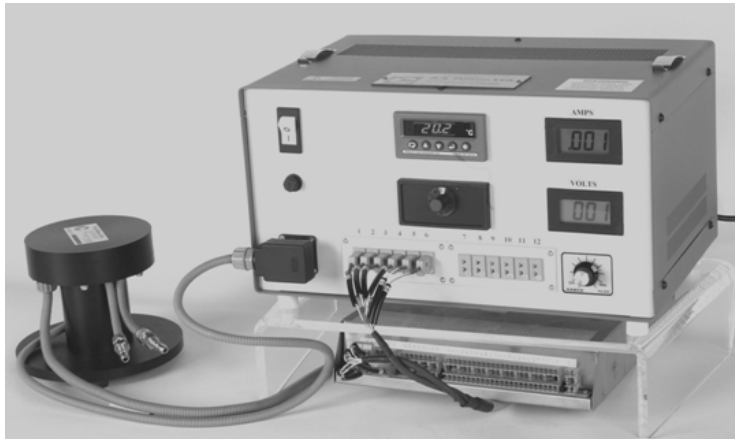
Σχήμα 3: Φωτογραφική απεικόνιση της πειραματικής συσκευής H102B, P. A. Hilton Ltd
